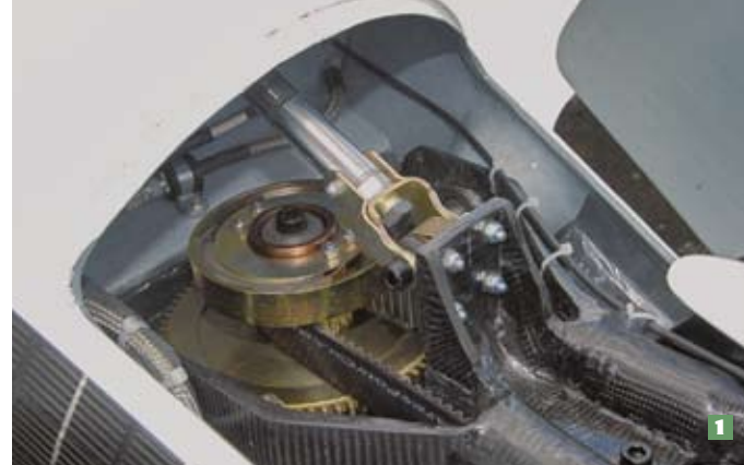
DIE FLIEHKRAFT-RUTSCHKUPPLUNG sorgt für ein langes Leben des Antriebsriemens und ermöglicht das Anlassen im Windmühleneffekt. 1
