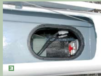
DIE FLIEHKRAFT-RUTSCHKUPPLUNG sorgt für ein langes Leben des Antriebsriemens und ermöglicht das Anlassen im Windmühleneffekt. 1
