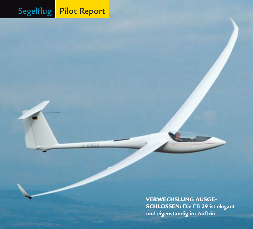
FLÜGELOPTION: Die EB 29 kann mit unterschiedlichen Ansteckflügeln mit 28,3 oder 29,3 m Spannweite geflogen werden.
