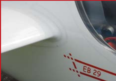
SAUBERER (leiser) Rumpf-Flügel-Übergang mit Mückenputzer-Garagen. Die Hauptbolzen können dank Abstufung noch innerhalb des engeren Einsitzerrumpfs eingesteckt werden.
