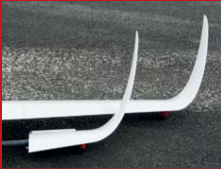
FLÜGELOPTION: Die EB 29 kann mit unterschiedlichen Ansteckflügeln mit 28,3 oder 29,3 m Spannweite geflogen werden.
